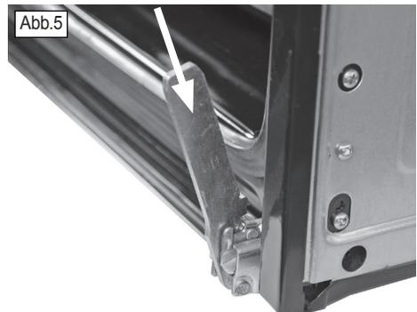
5. Die Backraumtür vollständig öffnen und die Klapp-Verriegelungen am linken und am rechten Scharnier wieder schließen, so dass sie wieder, wie in Abb. 1 dargestellt, positioniert sind.
